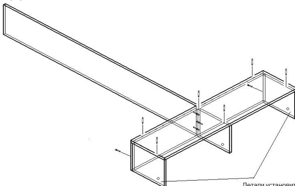
Детали установить эксцентриками во внутрь конструкции
