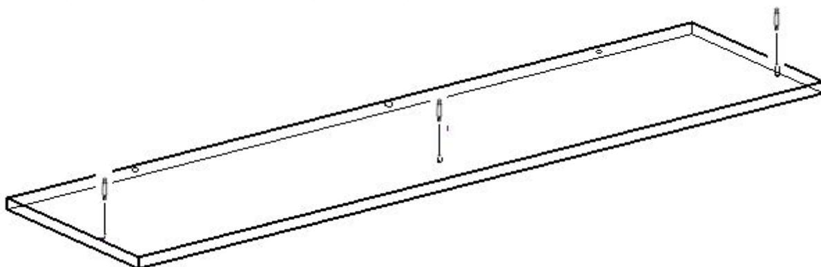
12. Присоединить деталь арт. 06.03.11 к конструкции и закрепить с помощью конфирматов
