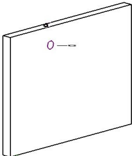
3. К детали арт. 06.03.16 присоединить детали арт. 06.03.18; арт. 06.03.19 - 3 шт. Закрутить эксцентрики минификсов
