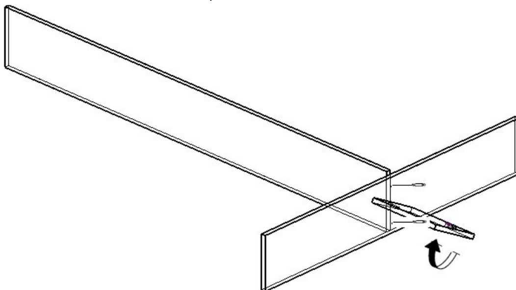
9. К конструкции присоединить детали арт. 06.03.13, арт. 06.03.15, арт. 06.03.12 с помощью конфирматов
