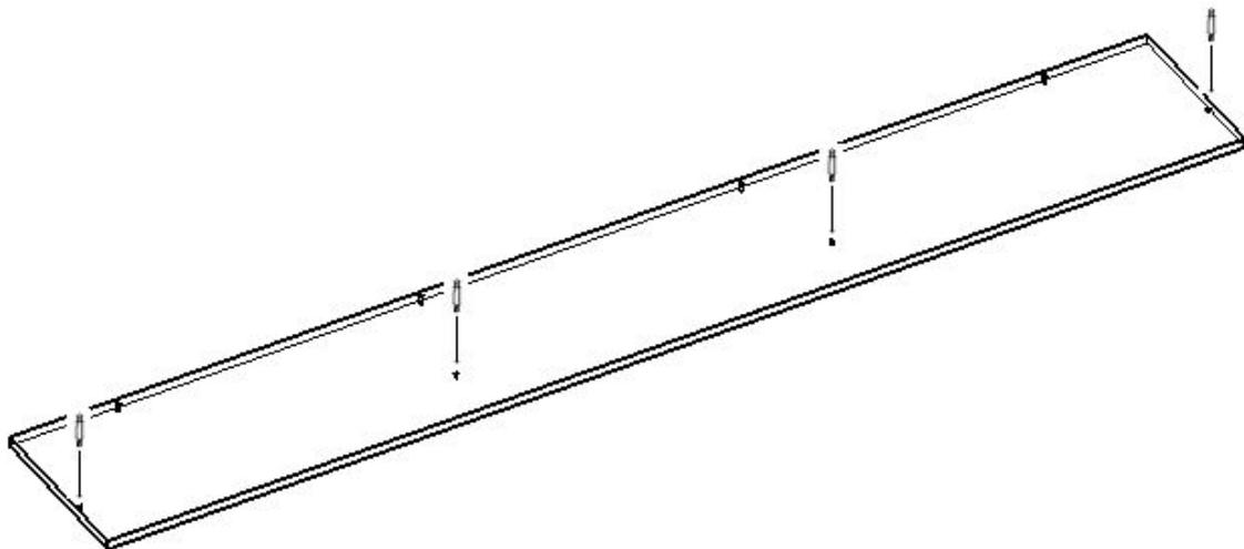
15. К детали арт. 06.03.07 присоединить детали арт. 06.03.09; арт. 06.03.10 - 3 шт. Закрутить эксцентрики минификсов.
